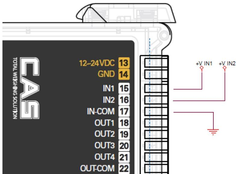
При подаче входного напряжения в диапазоне 5...24 В сигнал будет на каждой клемме.
