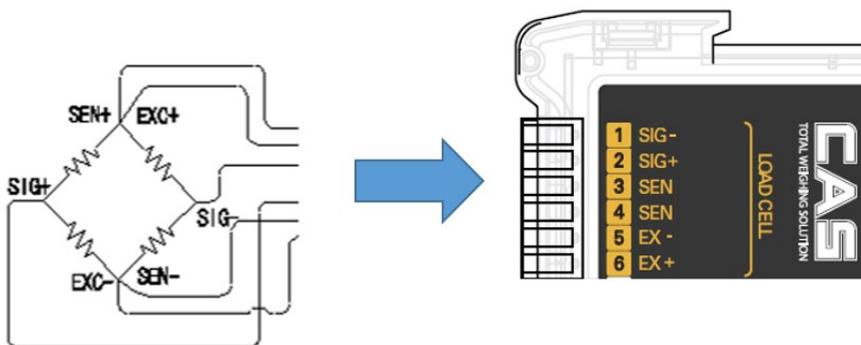
*Примечание 1. При использовании 4-проводного подключения датчика подсоедините контакт EX+ к контакту SEN+, а контакт EX- - к контакту SEN-.*
