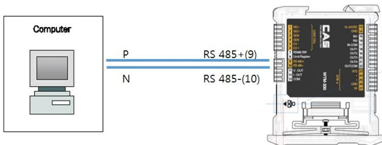
Если расстояние кабеля подключения при использовании канала RS485 превышает 100 метров, или скорость передачи превышает 9600 бит/сек, включите в приборе dip-переключатель ограничительного сопротивления RS-485. Данный переключатель подключен к сопротивлению 120 Ом между контактами '+' и '-' линии RS485.
