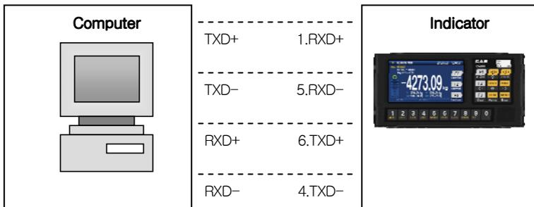
Рис. 12.1 - Схема подключения с использованием интерфейса RS-422
