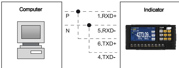
Рис. 12.2 - Схема подключения с использованием интерфейса RS-485
