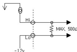
Выход по напряжению создает аналоговый выходной сигнал, эквивалентный по напряжению (0 ~ 10В) отображаемой на дисплее массе груза.
