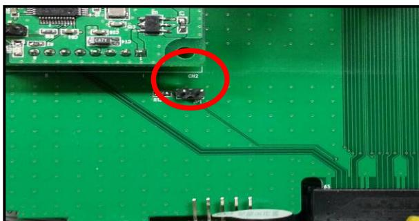
Рис. 8.1 - Контакты для входа в режим юстировки
